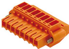
Buchsenleisten mit Schraubanschluss in Zugbügeltechnik für Leiteranschluss im Raster 3,50 mm. Sie bieten Platz für Beschriftungen und können kodiert werden.
