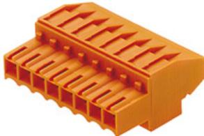
Buchsenleisten mit Schraubanschluss in Zugbügeltechnik für Leiteranschluss im Raster 3,50 mm. Sie bieten Platz für Beschriftungen und können kodiert werden.
