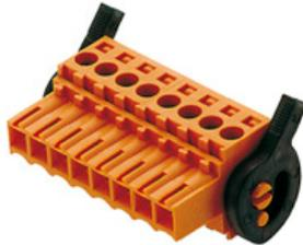
Buchsenleisten mit Schraubanschluss in Zugbügeltechnik für Leiteranschluss im Raster 3,50 mm. Sie bieten Platz für Beschriftungen und können kodiert werden.
