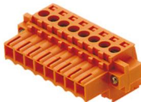
Buchsenleisten mit Schraubanschluss in Zugbügeltechnik für Leiteranschluss im Raster 3,50 mm. Sie bieten Platz für Beschriftungen und können kodiert werden.
